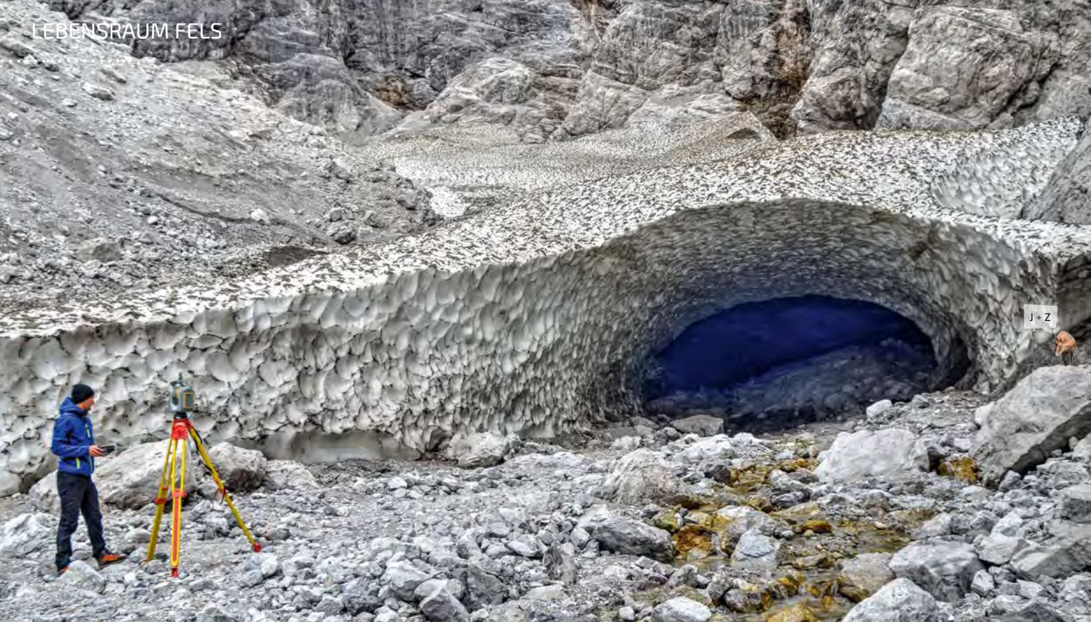
▲ Messarbeiten Geodätische Aufnahme des Höhleneingangs; Hochschule München (2017)
